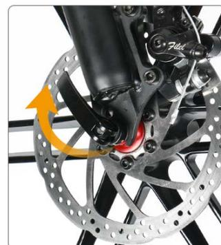
8. Lockez la poignée de dégagement rapide pour terminer l'installation de la roue avant.
