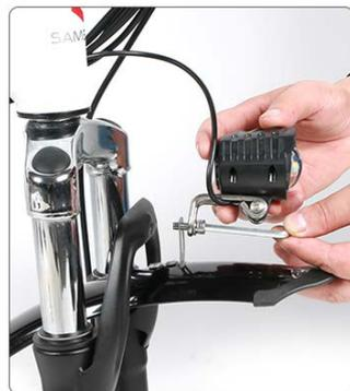
2. Fixez le phare et l'aile avant avec les vis et serrez-les fermement.
