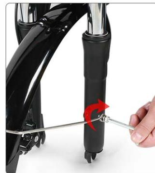
4. Serrez les supports des deux côtés de l'aile avant.
