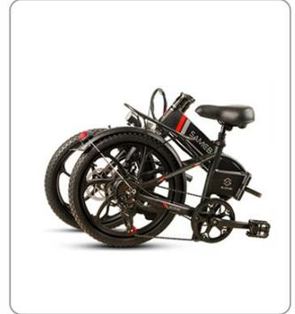
3. Ouvrir le dossier du cadre, plier la roue avant presque parallèlement à la roue arrière et terminer le pliage.
