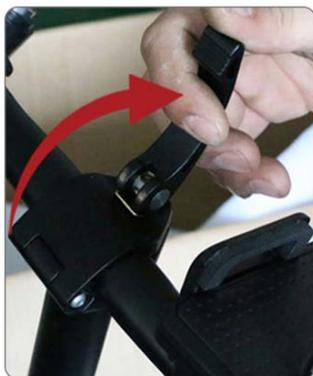
5. Desserrez le levier de dégagement rapide du guidon et réglez le guidon
