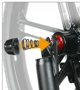
6. Serrez le ressort et l'écrou sur le boulon.
