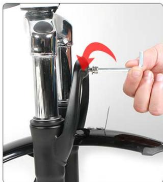
1. Bloquez les vis de la fourche avant avec un tournevis hexagonal.
