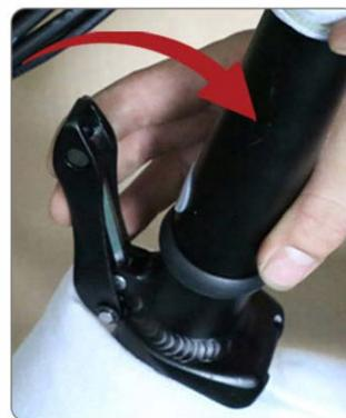
4. Plier le guidon et perpendiculairement au sol
