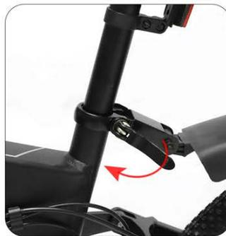
Après avoir réglé la direction et la hauteur du siège, verrouillez le levier de dégagement rapide.
