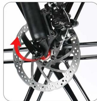
Verrouillez la poignée de dégagement rapide pour terminer l'installation de la roue avant.
