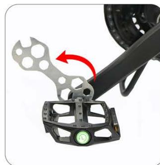
serrer la pédale gauche "L" dans le sens inverse des aiguilles d'une montre.
