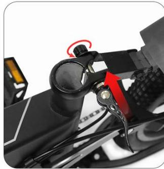
Positionnez le levier de serrage rapide et serrez le levier de serrage rapide en suivant le sens.
