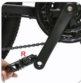
La pédale "R" est installée sur un côté du plateau, et la pédale "L" est installée sur le côté opposé du plateau.
