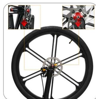
Installez le côté disque de l'e-bike dans la direction avec le frein à disque.
