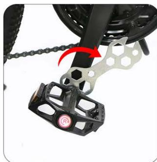
Serrer la pédale droite "R" dans le sens des aiguilles d'une montre.
