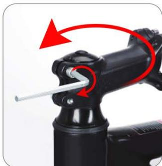
desserrer le boulon, la potence sera à 180° pour régler la direction.
