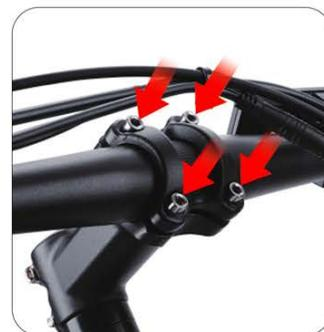
Serrez les 4 boulons pour fixer le guidon.
