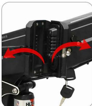
2. Cadre pliant. Ouvrez le cadre en pliant avec le fermoir de sécurité. Repliez les côtés gauche et droit du cadre.
