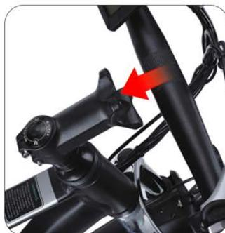
Installer le guidon pour régler la direction
