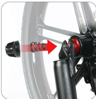
Serrez le ressort et l'écrou sur le boulon.
