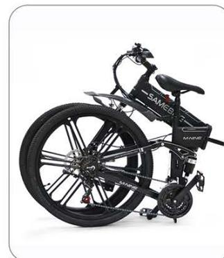
3. Ouvrir le dossier du cadre, plier la roue avant presque parallèlement à la roue arrière et terminer le pliage.
