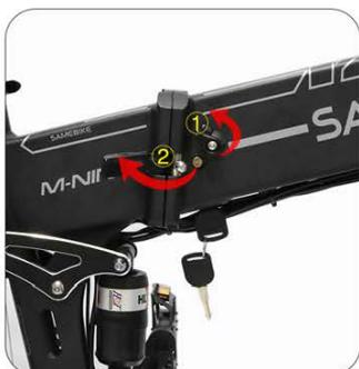
ouvrez la séquence de verrouillage dans le sens de la flèche
